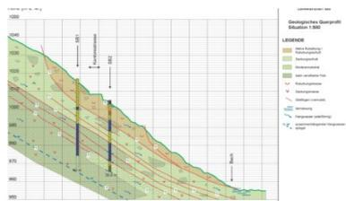
Geologisches Querprofil im Bereich der Lehenbrücke, erarbeitet mit Hilfe von Oberflächenaufschlüssen sowie den Bohrprofilen.
