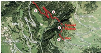
Situation der neuen Verbindungsstrasse nach Trans mit den verschiedenen Bauetappen (1, 2 und 4 - Zufahrtstrecken, 3 - Tunnel Plattas, Bild TBA GR).
