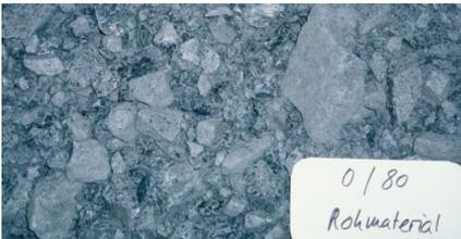
Wiederverwertbares Tunnelausbruchmaterial: Das Tunnelausbruchmaterial wird auf die Korngrösse 0/80 vorgebrochen, bevor es in die Kiesaufbereitung aufgegeben wird.
