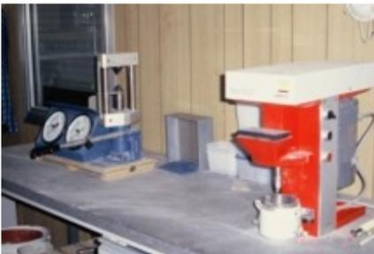
Qualitätsprüfungen an Tunnelausbruchmaterial: Die makroskopische petrographische Klassierung des Tunnelausbruchmaterials wird mittels Gesteinshärteprüfungen (Brechbarkeits- und Punktlastversuche) im Feldlabor überprüft.
