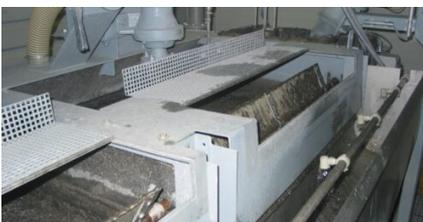
Kiesaufbereitung mit Flotation: Das Verfahren zur Abtrennung von ungeeigneten Glimmeranteilen aus den gneisigen Kristallingesteinen wurde in einem Grossversuch in Freiberg (Sachsen) überprüft.
