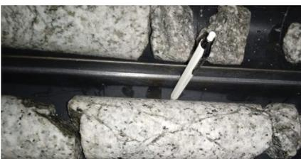
Bild 3: Aufnahme von Bohrkernen mit feinsten hydraulisch wirksamen Strukturen zur Beurteilung der mittels Bohrlochversuchen bestimmten Durchlässigkeiten
